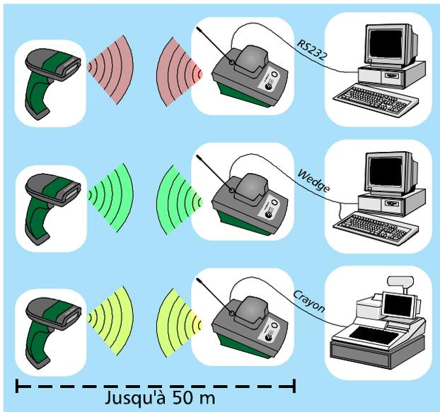
Fig. 1 - DLL6010-R connexion point à point
